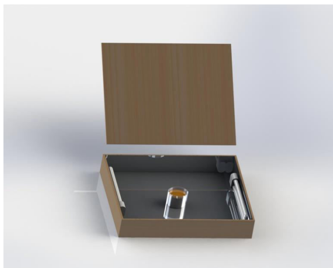
Figura 7. Reator utilizado para avaliação de degradação alimentícia com incidência de radiação luminosa
