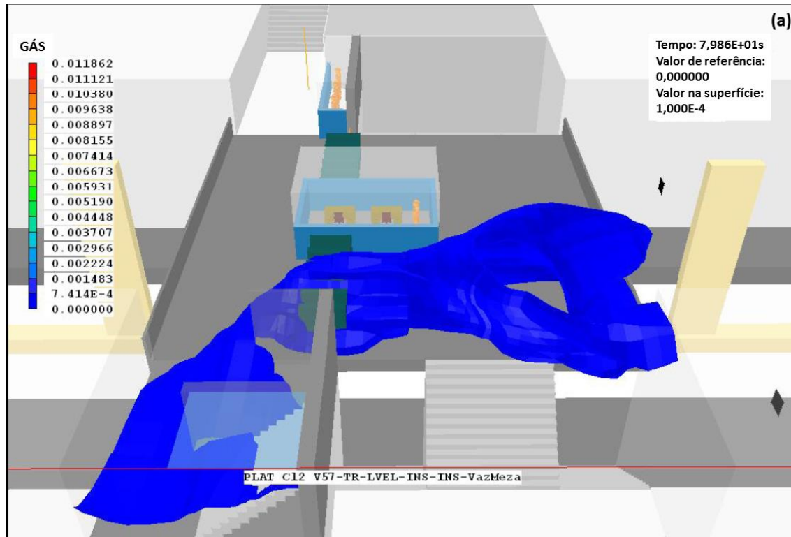
Figura 3. Superfícies de isoconcentração do gás cloro nos tempos: 7 (a) 7,5 s; (b) 40,0 s; (c) 65,5 s e (d) 70,0 s
