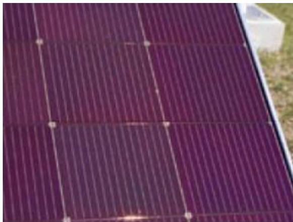
**Figura 8.** Painel de silício amorfo. Retirada do Sítio do Portal Energia – Energias Renováveis, reprodução com autorização
