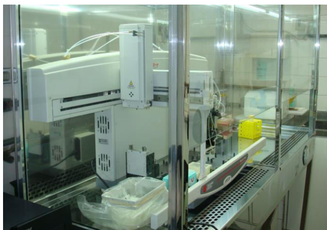
Figura 2. Estação automatizada ( High Throughput Screening – HTS) utilizada nos ensaios de citotoxicidade no Laboratório Nacional de Oncologia Experimental.
