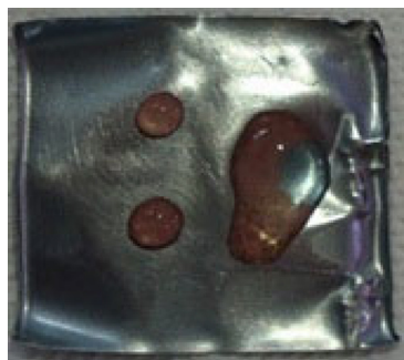
Figura 6. Superfície metálica mostrando o resultado da reação entre zinco metálico e íons \text{Cu}^{2+}(\text{aq})
