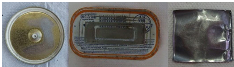
Figura 1. Tampa, lata e zinco metálico lixados e desengordurados
