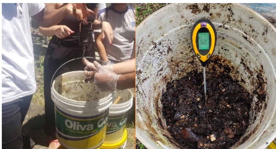
Figura 6. Análise final do processo de compostagem após cinco meses: Detalhe da aferição da massa do composto estabilizado para cálculo de rendimento e do monitoramento do pH para caracterização físico-química do adubo orgânico
