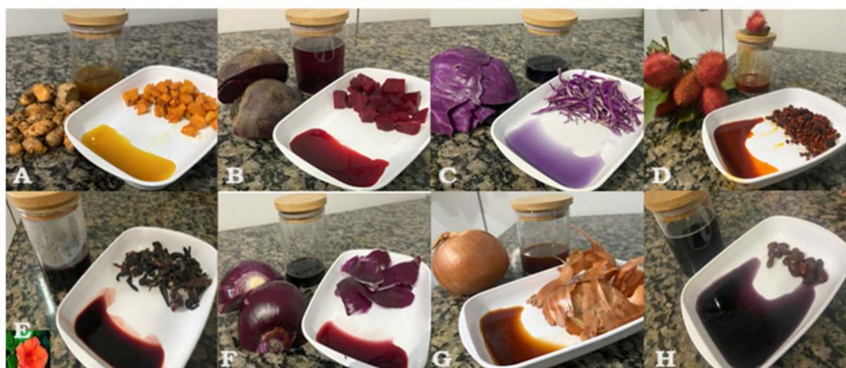
Figura 5. Ilustração de todos os resultados do procedimento de extração de corantes das diferentes matérias primas. (A- açafrão-da-terra; B- beterraba; C- repolho roxo; D- urucum; E- hibisco; F- cebola roxa; G- cebola amarela; H- feijão-preto)
