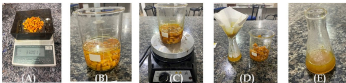
Figura 4. Fotografias que ilustram as etapas de extração do corante do açafrão da terra: (A) pesagem, (B) adição de etanol, (C) aquecimento, (D) filtração e (E) extrato
