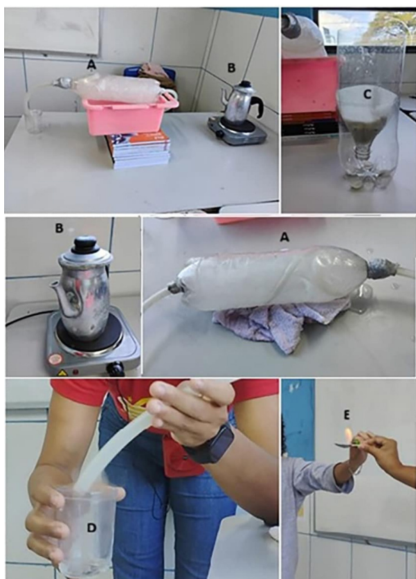
Figura 3. (A) Garrafa PET com água congelada; (B) Chaleira com a tampa selada com anel de silicone utilizando uma cola de cianoacrilato; (C) Funil feito com uma parte superior de garrafa PET e papel de filtro; (D) Recolhimento do etanol após a destilação; (E) Teste de ignição do etanol destilado realizado em colher metálica
