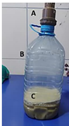
Figura 2. (A) Válvula bloqueadora; (B) Garrafa de Pet de 5 L; (C) mosto: 1 L de caldo de cana-de-açúcar misturado a 40 g de fermento biológico seco
