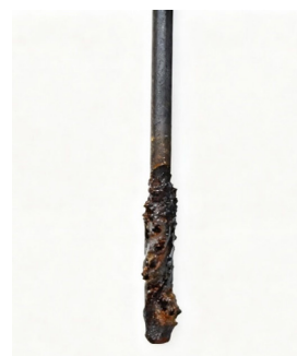
Figura 7. Eletrodo de grafite com depósito de ferro metálico (parcialmente oxidado), após 120 minutos, em tensão de 1,5V
