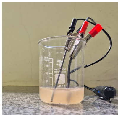
Figura 2. Célula eletrolítica com anodo de magnésio e catodo de grafite, conectados a pilha de 1,5V
