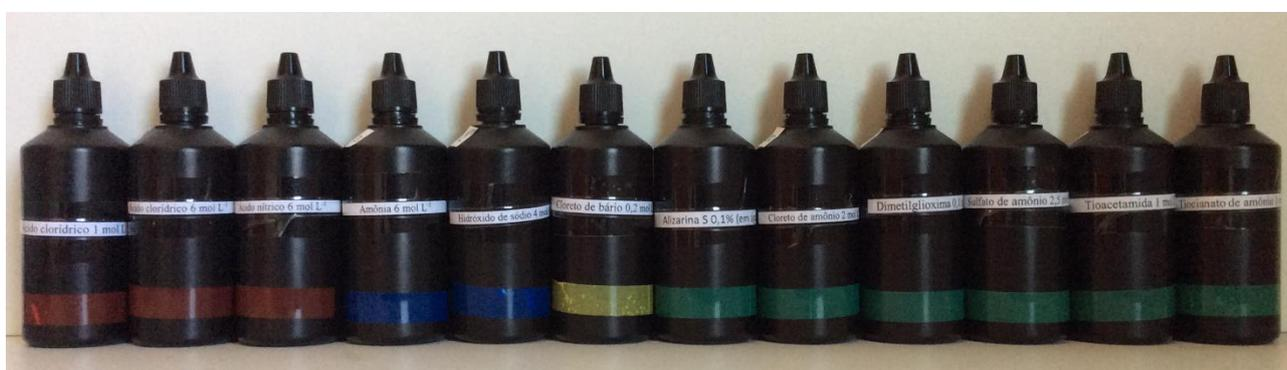
**Figura S2.** Frascos rotulados contendo as soluções utilizadas para realizar as reações químicas envolvidas na separação dos cátions e identificação do  $\text{Ni}^{2+}$  nas amostras. As cores vermelha, azul, amarela e verde das fitas adesivas são referentes ao tipo de substância: ácidos, bases, sais de íons metálicos e outras substâncias, respectivamente
