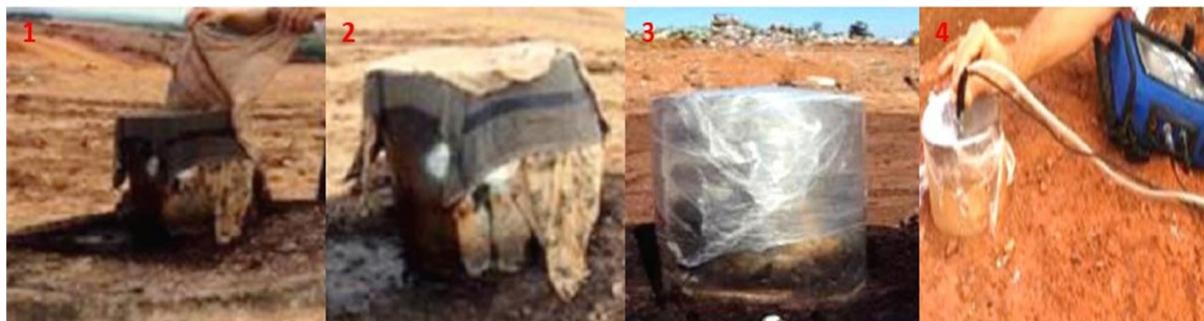
Figura 3. Procedimento para aferição da composição do biogás
