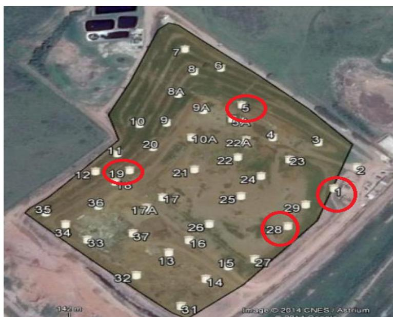
Figura 2. Aterro sanitário de Rio Claro com a disposição dos drenos de biogás
