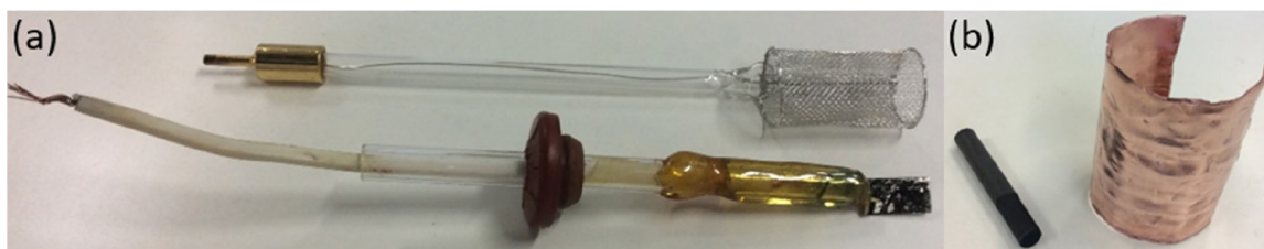
Figura 3. (a) Eletrodo de rede de platina (cima) e eletrodo de placa de platina platinizada (baixo); (b) eletrodo de grafite de pilha exaurida (à esquerda) e eletrodo de placa de cobre (à direita)
