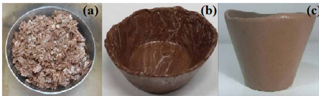
Figura 4. (a) PS em grânulos, rejeito e óleo; (b) amostra de madeira plástica com 30% de rejeito e (c) amostra de madeira plástica com 40% de rejeito
