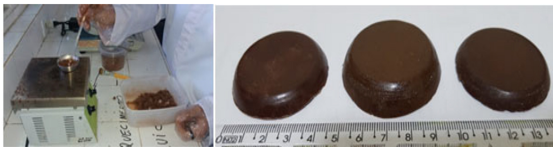
Figura 5. Amostra de madeira plástica desenvolvida pelos alunos
