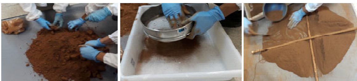
Figura 1. Preparação da amostra segundo a ABNT 10007:2004 (quarteamento)
