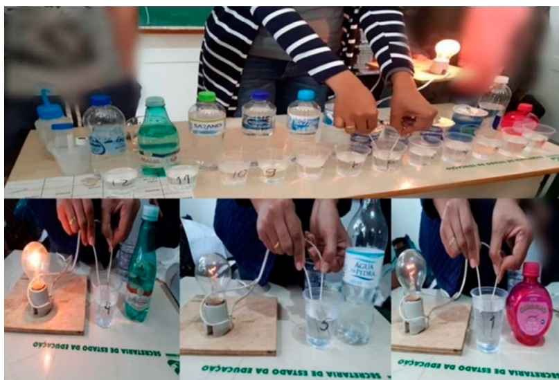
Figura 9. Imagem da docente realizando o experimento usando o circuito elétrico com a lâmpada para a medida de condutividade elétrica em algumas marcas de água mineral
