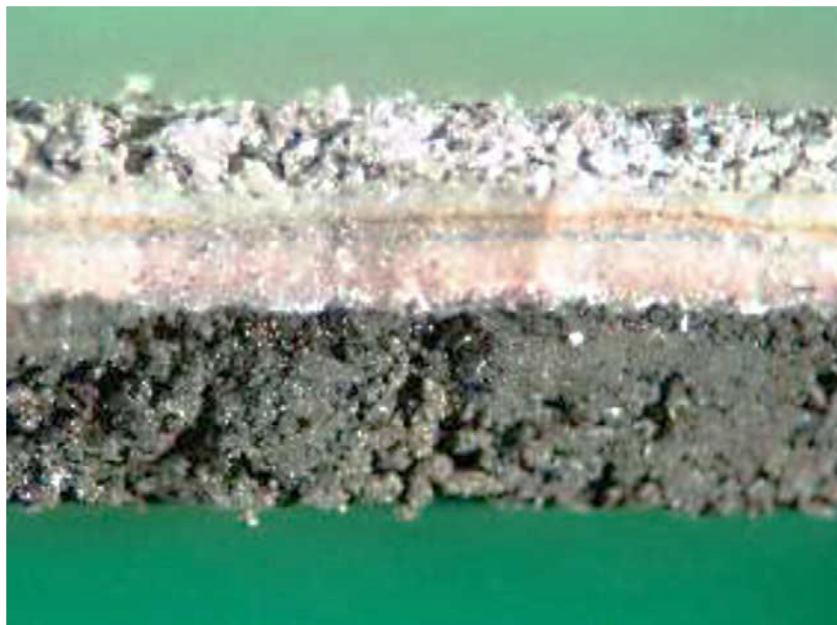
Figura 14. Ilustração de diferentes camadas que aparecem no separador de uma bateria térmica após aquecimento e eventual descarga. Em baixo: \text{FeS}_2 (eletrodo positivo) e em cima \text{Li(Al)} (eletrodo negativo). 45 (Reprodução da ref. 45 com autorização. Copyright © 2005 Elsevier, E.U.A.)
