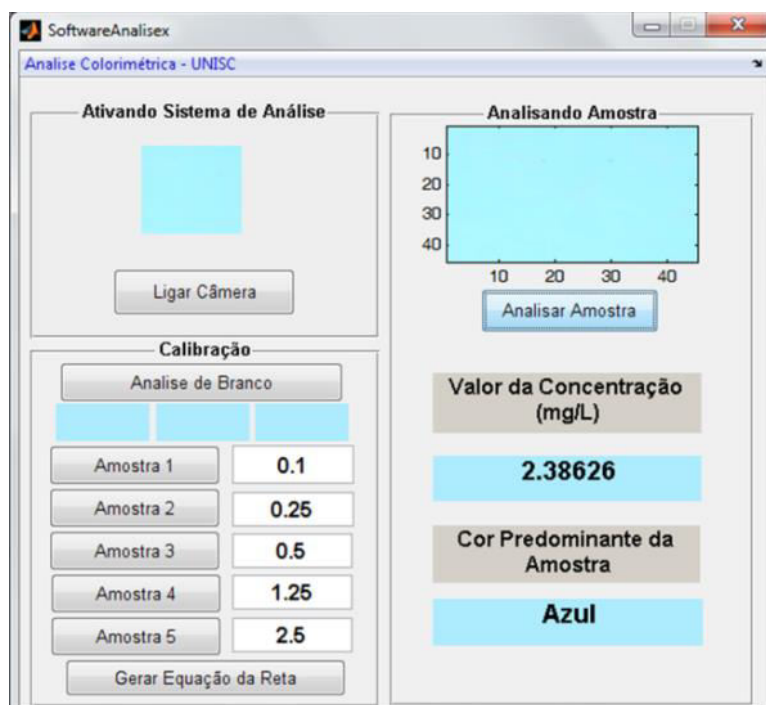
Figura 4. Imagem da interface gráfica do software para controle de aquisição e tratamento de imagens digitais
